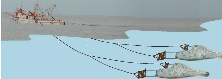
Fig. 9. Esquema general de arrastre por banda de doble aparejo.
