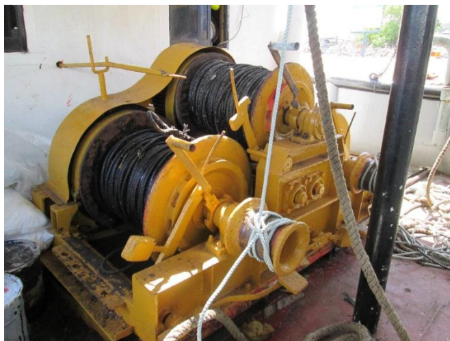
Fig. 2. Winche típico camaronero R-700 utilizados en las pruebas.
